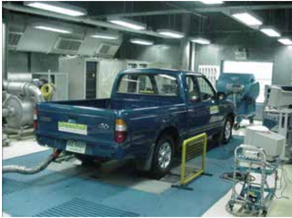
การทดสอบผลกระทบของเชื้อเพลิงดีโซฮอล์ ต่อสมรรถนะและปริมาณสารมลพิษในเครื่องยนต์ดีเซล
