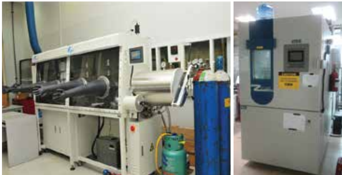
เครื่องมือและอุปกรณ์ที่ทันสมัย Glove Box และ Environmental Chamber รองรับการทำงานด้านแบตเตอรี่และระบบการกักเก็บพลังงานที่มีประสิทธิภาพ
