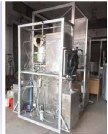
หน่วยผลิตไฮโดรเจนจากเอทานอลที่ทำการออกแบบโดยใช้โปรแกรม CAD (ซ้าย) และหน่วยผลิตไฮโดรเจนที่ประกอบเสร็จสมบูรณ์ (ขวา)
