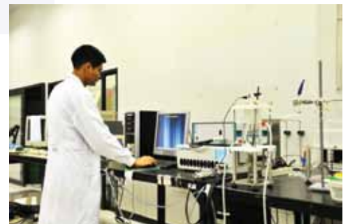
การวิเคราะห์ตัวอย่างท่ออลูมิเนียม ด้วยเทคนิคโพเทนชิโอสแตติก
