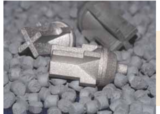
ชิ้นงานเหล็กกล้าไร้สนิมขึ้นรูปด้วยวิธีการฉีดขึ้นรูปผงโลหะ
