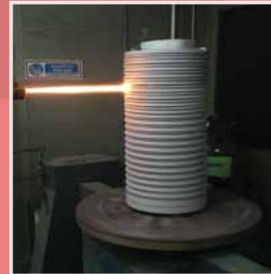
การเคลือบผิวชิ้นส่วนอุตสาหกรรมสีทอง เพื่อปรับปรุงสมบัติการต้านทานการสึกกร่อน
